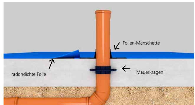
Sichere Abdichtung der Abwasserleitung mit einem Mauerkragen und Einbindung der radondichten Folie über eine Folien-Manschette.
